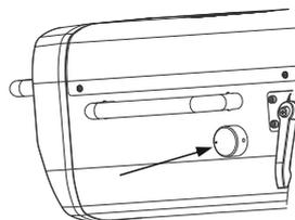
Die Helligkeit des Scheinwerfers wird über den Dimmer Drehregler eingestellt.
